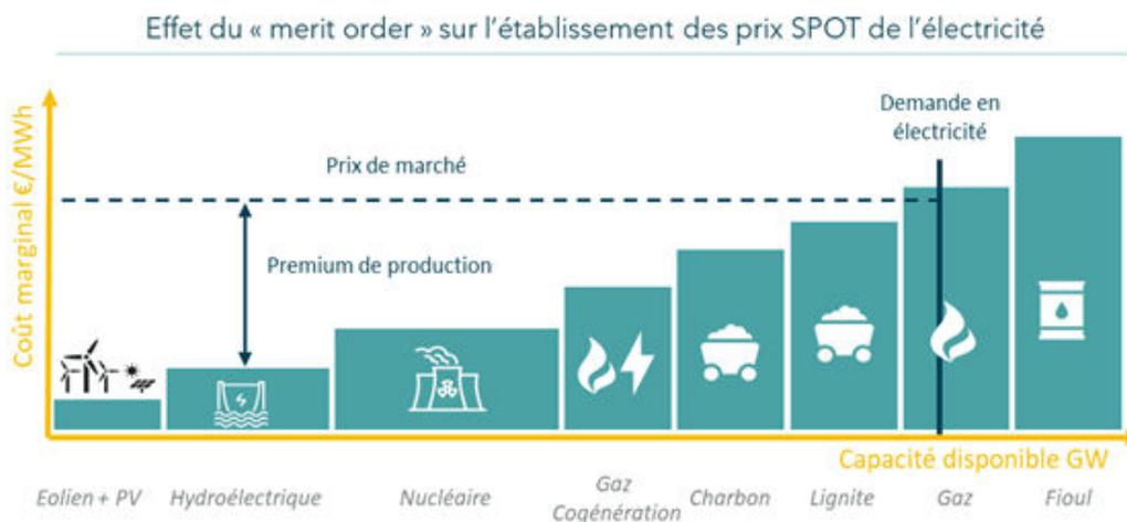
Figure 1 : Ordre d'appel des moyens de production d'électricité [2]
