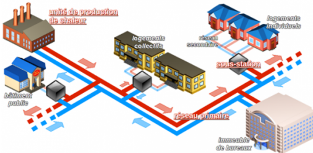
FIGURE 2 : SCHÉMA RÉSEAU DE CHALEUR (SOURCE : CEREMA SUR LE SITE DU MINISTÈRE ÉCOLOGIE ÉNERGIE TERRITOIRES 2023)
