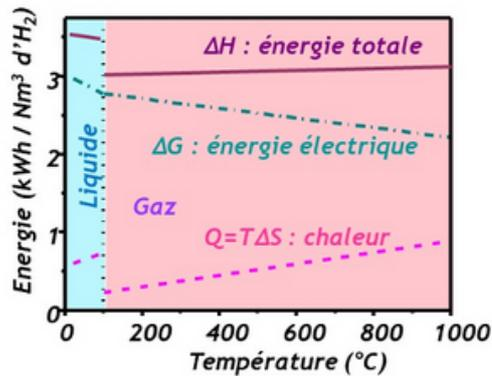
Figure 4 : Besoin énergétique pour la réaction d'électrolyse en fonction de la température ; enthalpie ( $\Delta H$ ), enthalpie de Gibbs ( $\Delta G$ ), entropie ( $T\Delta S$ ) [figure d'après <sup>24</sup>]
