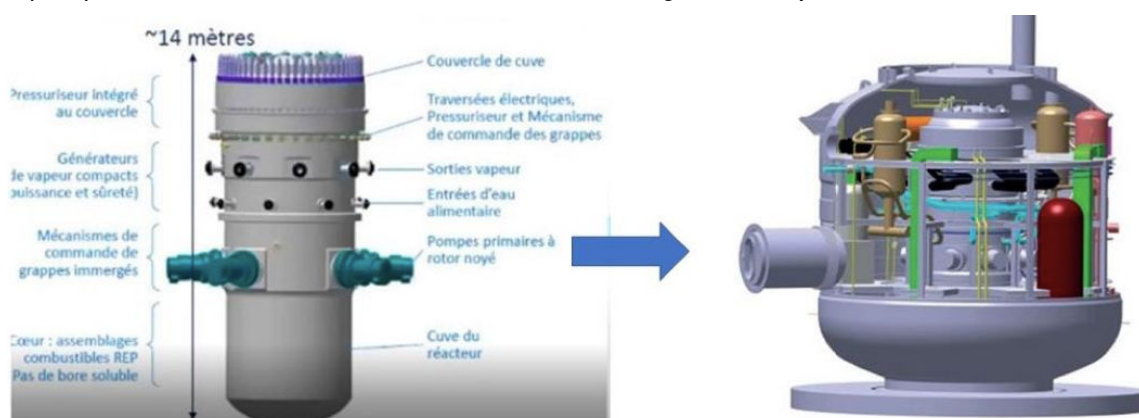
Figure 1. Cuve et enceinte "coquetier"
